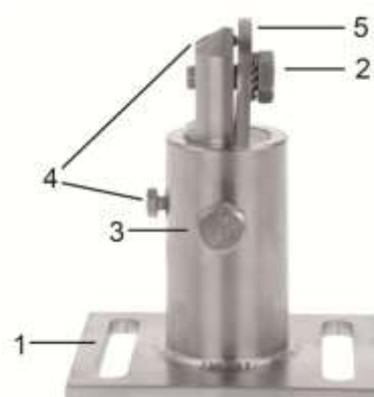
Si raccomanda di fissare la piastra (1) del supporto orientabile HM2 mediante almeno due viti M10 su una struttura meccanica stabile. Per alloggiare la barriera reflex PROXITRON sul supporto, allentare e togliere la vite M10x25mm (2) e la piastrina (5). Inserire la flangia del sensore fra l'albero mobile del supporto e la piastrina (5); quest'ultima evita che durante il serraggio della vite (2), il sensore possa spostarsi con conseguente perdita dell'allineamento.
