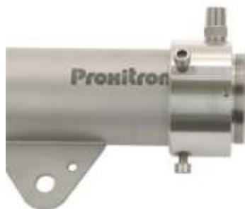
Per proteggere l'ottica dalla sporcizia è possibile dotare la barriera reflex PROXITRON di un attacco aggiuntivo per il soffiaggio d'aria. Si consiglia una pressione di 0,15 bar che corrisponde a un consumo di 60 l/min. La pressione max di esercizio è di 0,3 bar. Per evitare di sporcare l'ottica si raccomanda l'impiego di aria asciutta e pulita, priva di oli o di polveri. Per ottimizzare l'efficacia del soffiaggio, si consiglia di montare sull'attacco un tubo aggiuntivo, tipo OL 37 oppure OL 38.
