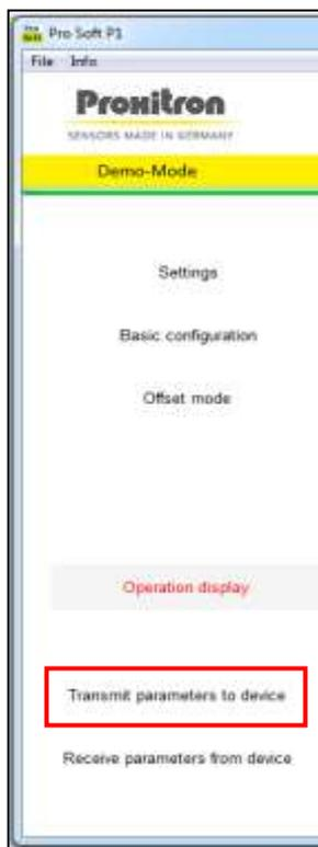
Selezionando **Transmit parameters to device** le impostazioni attualmente presenti nel software vengono trasferite al sensore.
