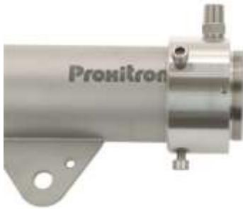
Per proteggere l'ottica dalla sporcizia è possibile dotare la barriera PROXITRON di un attacco aggiuntivo per il soffiaggio d'aria. Si consiglia una pressione di 0,15 bar che corrisponde a un consumo di 60 l/min. La pressione max di esercizio è di 0,3 bar. Per evitare di sporcare l'ottica si raccomanda l'impiego di aria asciutta e pulita, priva di oli o di polveri. Per ottimizzare l'efficacia del soffiaggio, si consiglia di montare sull'attacco un tubo aggiuntivo, tipo OL 37 oppure OL 38.
